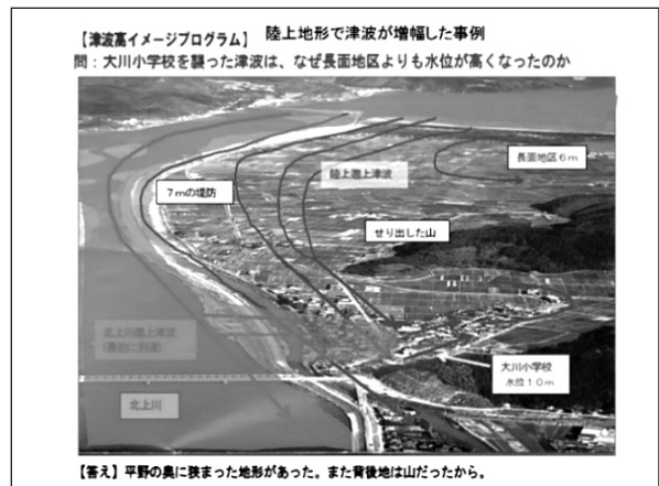
図2 陸上地形で津波が増幅した事例
